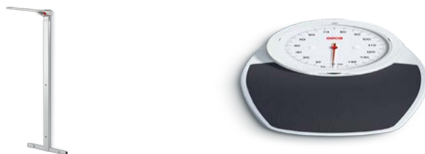
الشكل 03: يمثل جهازي (Seca 750 + Seca 222) لقياس الطول و الوزن.
